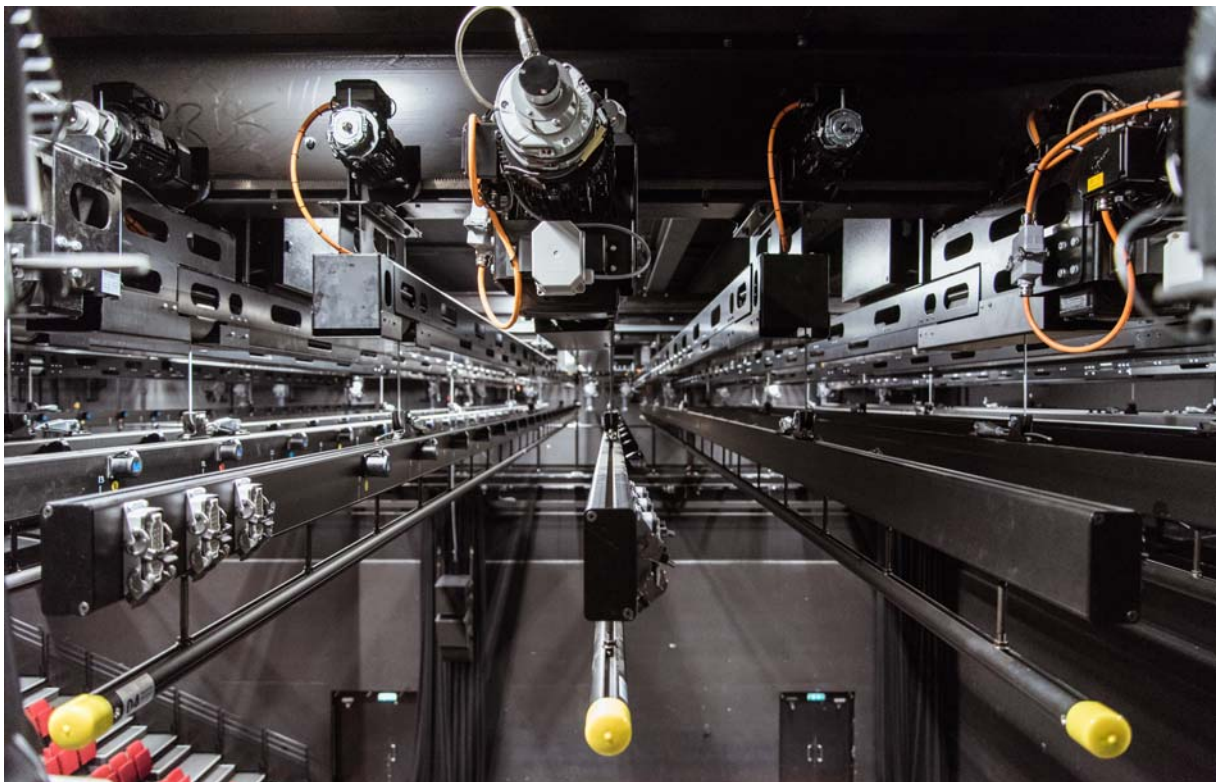
In de nieuwe installatie van DTS2 werden in het Theater aan het Spui circa 40 motorreductoren van NORD DRIVESYSTEMS toegepast. Daarbij zorgen tandwielreductoren voor de horizontale verplaatsingen en vlakke tandwielreductoren voor de verticale bewegingen. Foto: DTS 2 .
